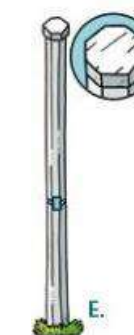
Système d'obturation de poteaux - Source : Conseil général Isère, 2010
